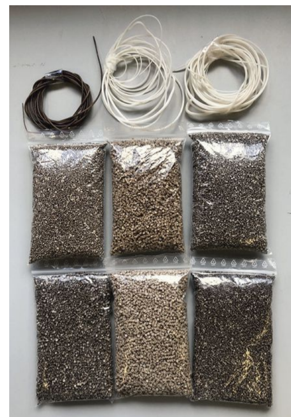
Pellet e cavi in bioplastica prodotti con gli scarti della produzione di birra Messina a Roccavaldina, borgo sui monti Peloritani. In basso, un'immagine del modello dei nuovi capannoni
